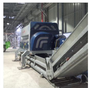
GRANULATORE PER ADEGUARE IL CSS ALLE SPECIFICHE DI PEZZATURA RICHieste
