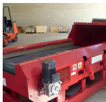
SEPARATORE A CORRENTI INDOTTE, PER RECUPERARE ALLUMINIO, ECC
