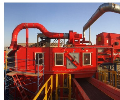
SQUIRREL, CLASSIFICATORE D'ARIA, PER SCARTARE LA FRAZIONE AD ALTA DENSITÀ, DAL BASSO POTERE CALORIFICO
